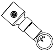
沉淀物及气泡均存在的安装
